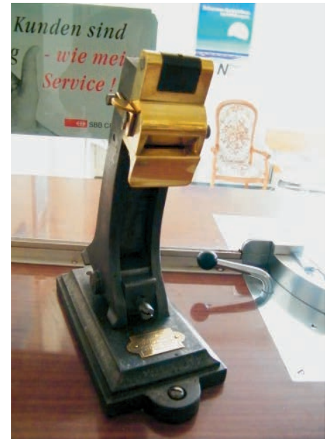
Beim Verkauf einer Fahrkarte wurde das Datum eingepresst.
