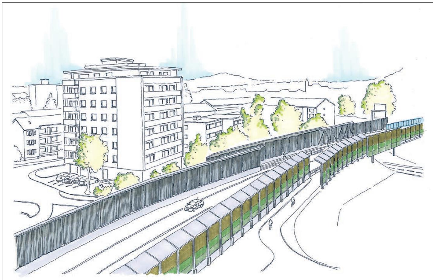
Lärmschutzwände im besagten Teilstück der T6
